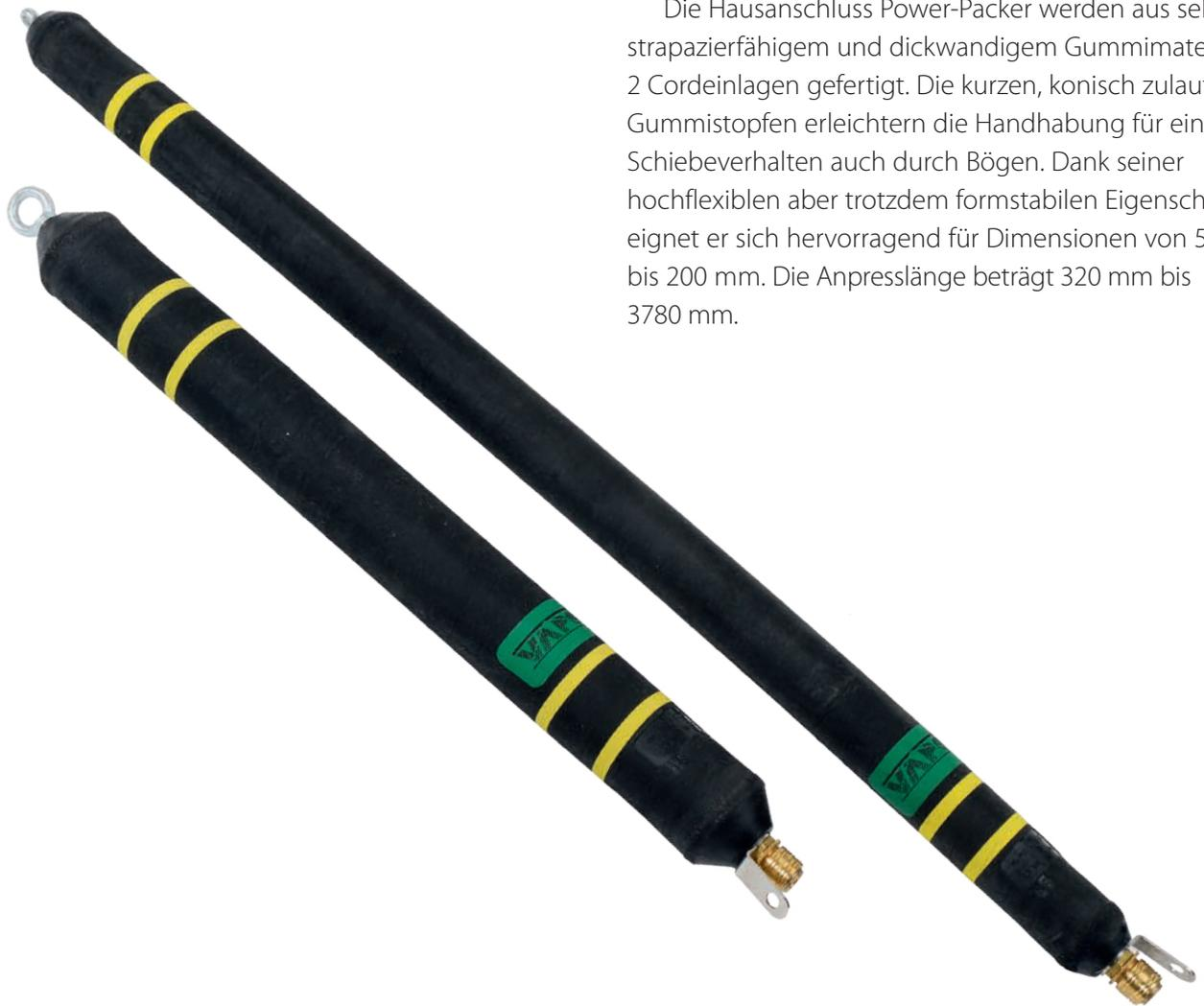
Die Hausanschluss Power-Packer werden aus sehr strapazierfähigem und dickwandigem Gummimaterial mit 2 Cordeinlagen gefertigt. Die kurzen, konisch zulaufenden Gummistopfen erleichtern die Handhabung für ein ideales Schiebehaviorhalten auch durch Bögen. Dank seiner hochflexiblen aber trotzdem formstabilen Eigenschaft, eignet er sich hervorragend für Dimensionen von 50 mm bis 200 mm. Die Anpresslänge beträgt 320 mm bis 3780 mm.
