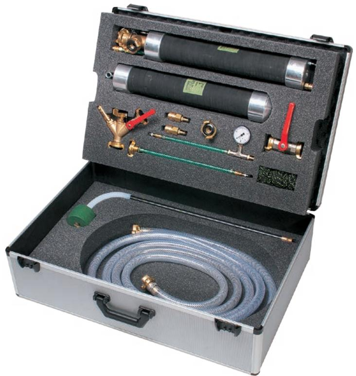
Dieses Prüfset ist für Dichtheitsprüfungen der Rohrleitungen von 100–200 mm Nennweite mit Luft und Wasser bestimmt. Es eignet sich sowohl für gerade Rohrabschnitte als auch für Bögen und Knierohre. Das Set beinhaltet alle für Dichtheitsprüfungen nach DIN EN 1610 erforderlichen Armaturen und Zubehörteile.
