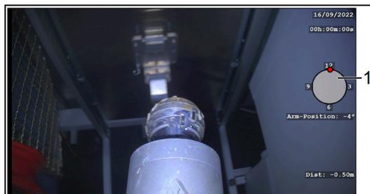
Bei Einsatz einer Kreis- und Schwenkkopf-kamera mit integriertem Positionsgeber kann die Bewegung als Grafik (1) oder als °-Anzeige dargestellt werden.
